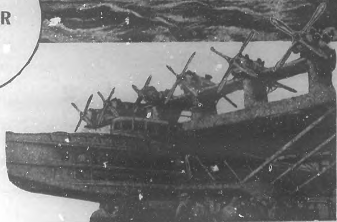
Vista parcial del enorme transatlántico aéreo, mostrando los doce motores de 500 caballos de fuerza cada uno, con sus hélices de cuatro paletas.
